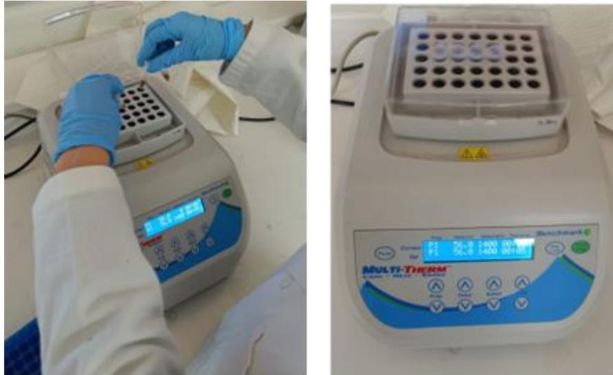
Figura 10. Muestras en incubación a 1400 rpm por 5 minutos.
