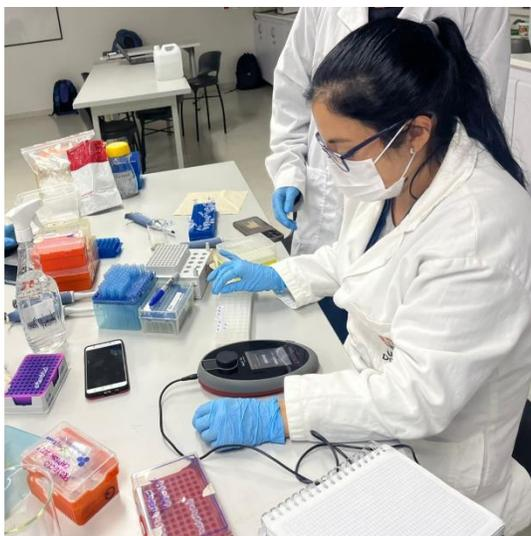
Figura 22. Cuantificación de ADN y RNA por fluorometría utilizando el equipo fluorómetro Qubit® 2.0 (Invitrogen).
