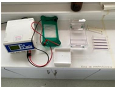
Equipos y preparación de electroforesis
