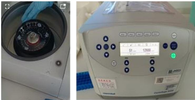
Figura 13. Centrifugación de las muestras a 12.900 xg
