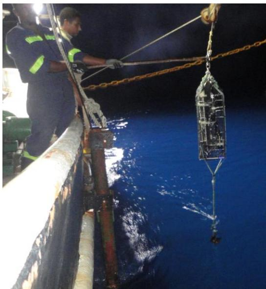
*Figura 5-6. Trabajo de muestreo oceanográfico con sonda CTDO, durante el crucero de prospección de calamar en el Pacífico colombiano.*
