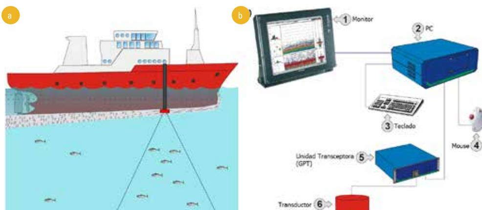
**Figura 5-1** a) Montaje del transductor en la parte lateral del barco para la detección instantánea de peces. b) Diagrama del sistema de información hidroacústica para visualización de las ecodetecciones (ecograma). **Fuente:** Tomado y modificado de Manual SIMRAD EK60 (2003).
