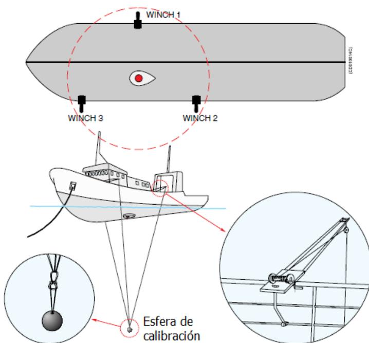
**Figura 5.2** Esquema de calibración de la ecosonda mediante una esfera con fuerza de blanco conocida y suspendida bajo el eje del haz acústico del transductor. **Fuente:** Tomado y modificado de Manual SIMRAD EK60 (2003).
